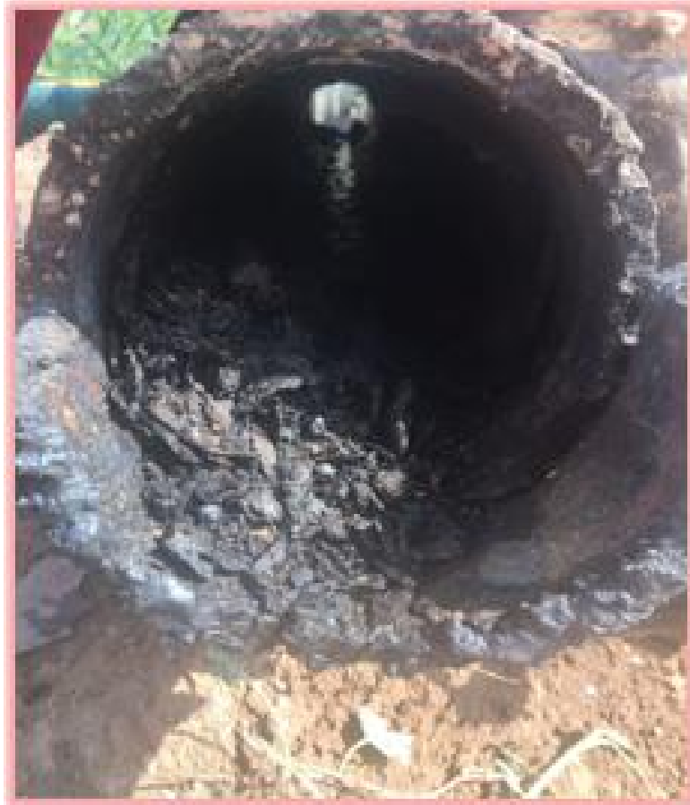
图 2.3-3 管线腐蚀穿孔结垢示意图
